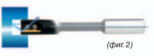
Для глухих отверстий рекомендовано использовать диапазон SR 81. Выходные отверстия подачи СОЖ расположены на передней части инструмента, давление СОЖ выталкивает стружку назад.
