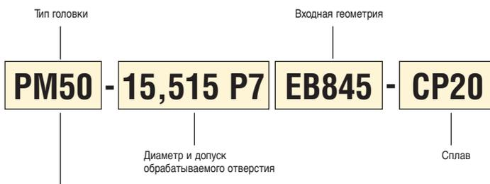
PM50 = Стандартное решение - для развёртывания сквозных отверстий. Выходы отверстий подачи СОЖ расположены сзади режущей головки, давление СОЖ выталкивает стружку вперёд.
