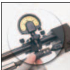
Настройте индикатор на 0 используя цилиндрические задние концы направляющих подкладок ③.
