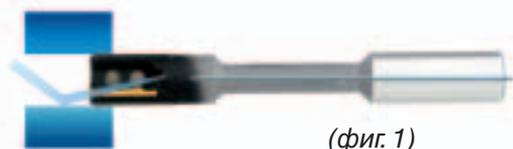
Диапазон SR 80 разработан для обработки сквозных отверстий. Выход каналов подачи СОЖ находится сзади лезвия, поток СОЖ толкает стружку вперёд.
