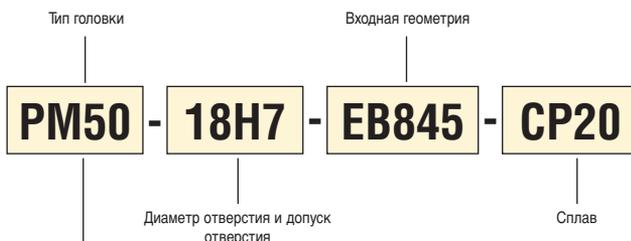
PM50 = Стандартное решение - для развёртывания сквозных отверстий. Выходы отверстий подачи СОЖ расположены сзади режущей головки, давление СОЖ выталкивает стружку вперёд.
