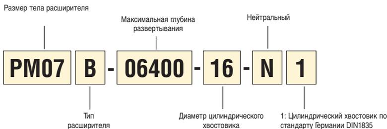
PM07 = Стандартное решение - для развёртывания сквозных отверстий. Выходы отверстий подачи СОЖ расположены сзади режущей головки, давление СОЖ выталкивает стружку вперёд.
