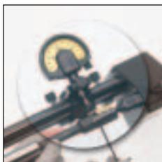
Настройте задний конец пластины на диаметр так чтобы обеспечить обратный конус 0,01 мм/10 мм длины лезвия (см. фиг. 2).
