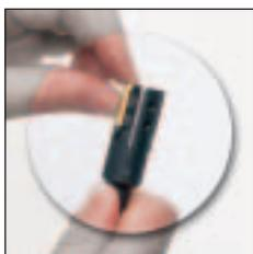
Сильно прижать лезвие к стопорному винту и отрегулировать шарики ⑥.
