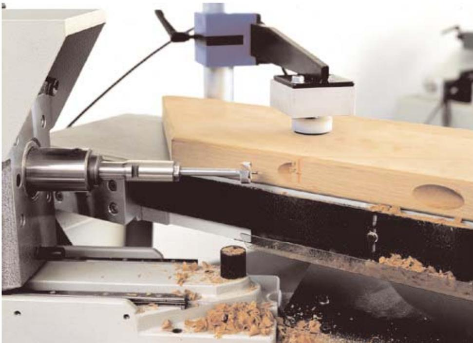
**Изготовление элементов лестниц с помощью сверл-фрез System**
