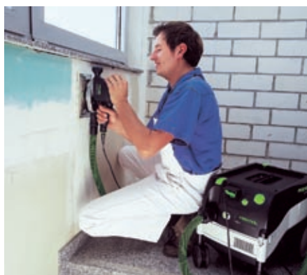
Пылеудаляющие аппараты CTL сводят к минимуму содержание пыли в воздухе во время шлифования.
