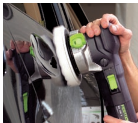
3. Полирование: блестящие поверхности без голограмм достигаются благодаря использованию эксцентрико-вращательного движения ROTEX.
