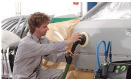
Шлифование и пылеудаление объединяет инструментальный центр.
