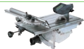
Торцовочный модуль MOD 1 A/ATF 55 E плита для крепления Basis 1 A/T; угловой упор Basis WRA 500; ATF 55 E с HW пильным диском Z48; толкатель; вспомогательный инструмент № для заказа: 570111
