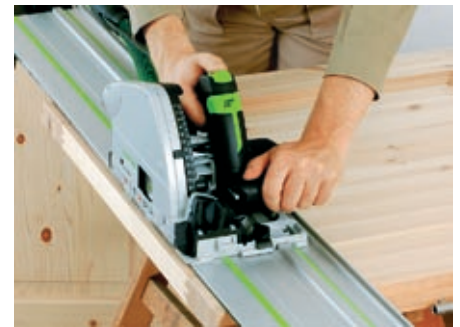
Быстрая и аккуратная распиловка материала: шина-направляющая плюс погружная пила.
