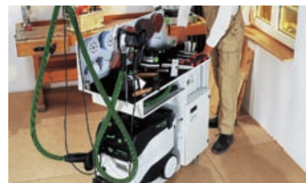
Передвижной инструментальный центр транспортирует все оборудование (на рисунке показано нестандартное оснащение).
