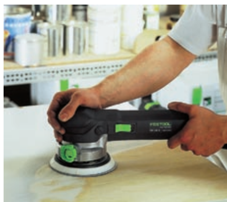
1. Грубое шлифование/съем: интенсивный съем, чистый рисунок шлифования благодаря использованию эксцентрико-вращательного движения ROTEX.
