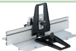
Basis 6 A, плита для крепления для OF 1400 или OF 2000; в сборе с защитным устройством, упором и регулятором высоты; макс. диаметр фрезы: 70 мм № для заказа: 570107
