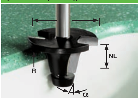
Фреза для снятия фасок со скругленной кромкой с опорным подшипником ②
