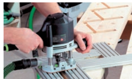
С помощью удлинительного профиля можно точно изготовить тетиву лестницы.
